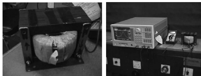
Figura K.8. Analizador de señales HP 35665 y autotransformador experimental.
